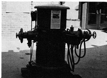
30 K.W. ARC Converter
